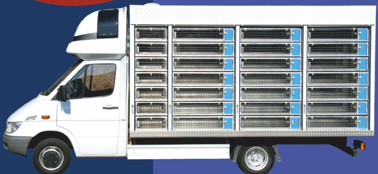
Transporter mit Dach-Schlafkabine für ca. 1.600 Tauben Transporter with Topsleeper for approx. 1.500 pigeons
